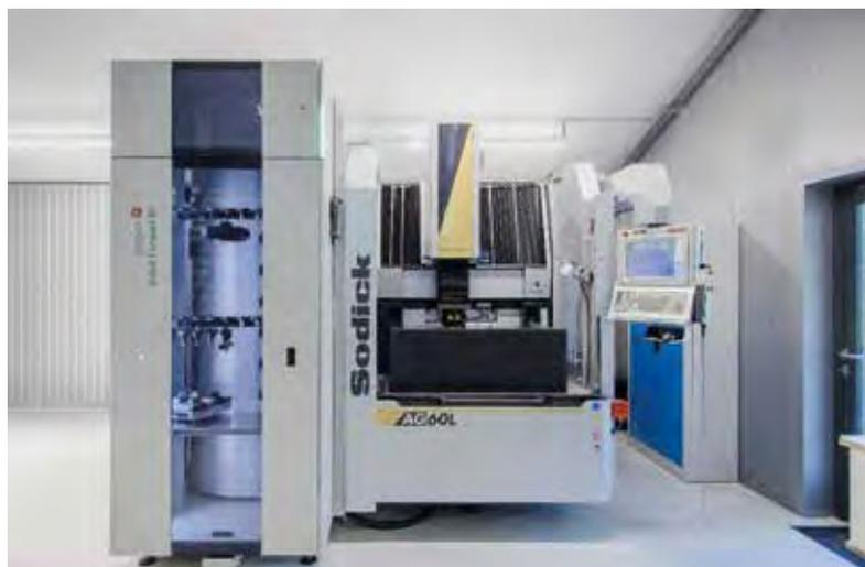
**Sodick AG60L bei BKV Braun:** Hochpräzise Senkerodiermaschine mit EROWA Automation
